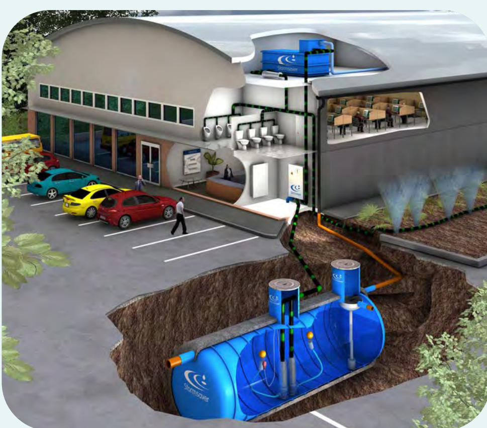
Récupération de l'eau de pluie
